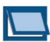
vyklopení směrem dovnitř
